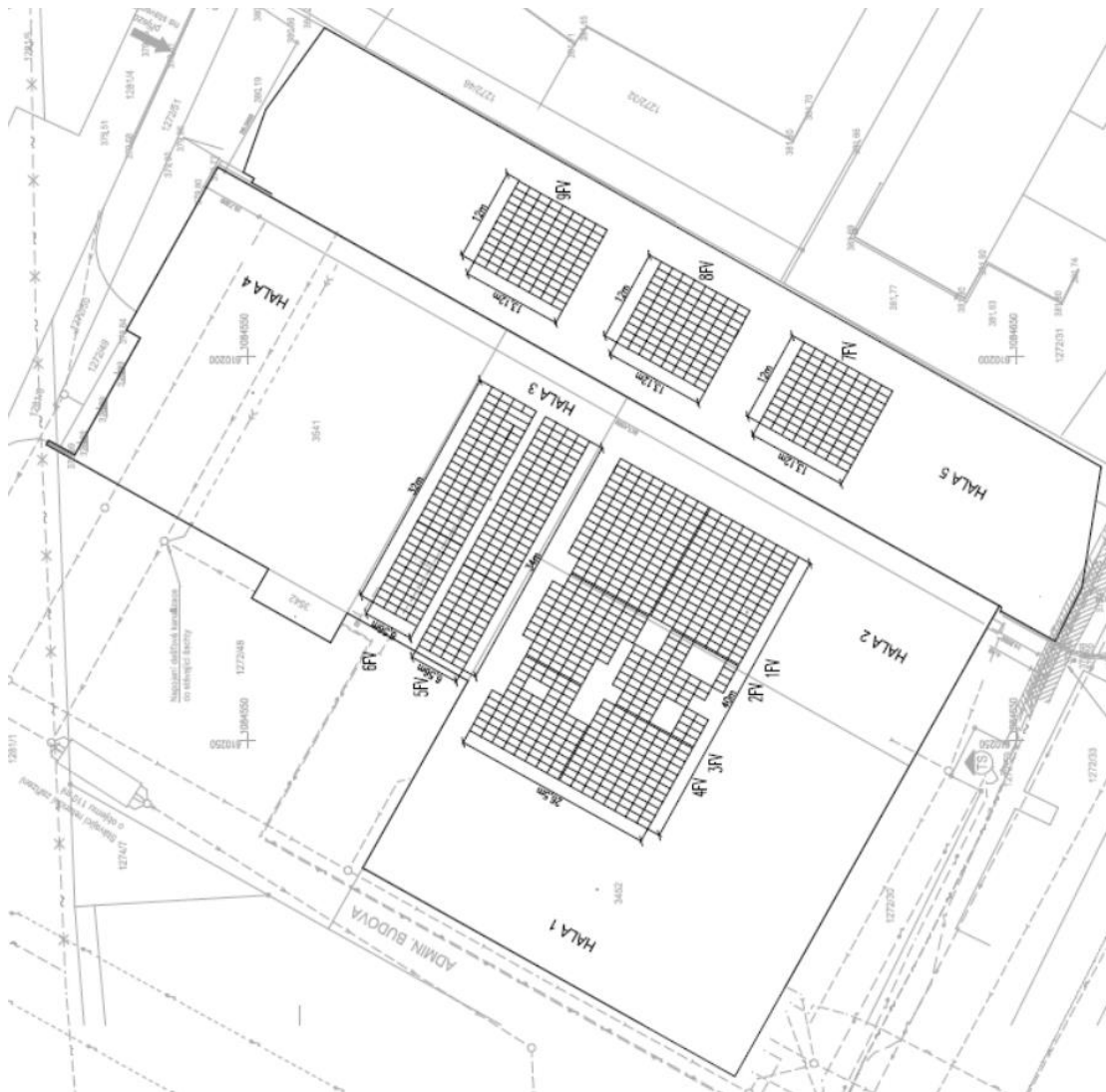
Obrázek 2 Plánované osazení panelů na střešních plochách
